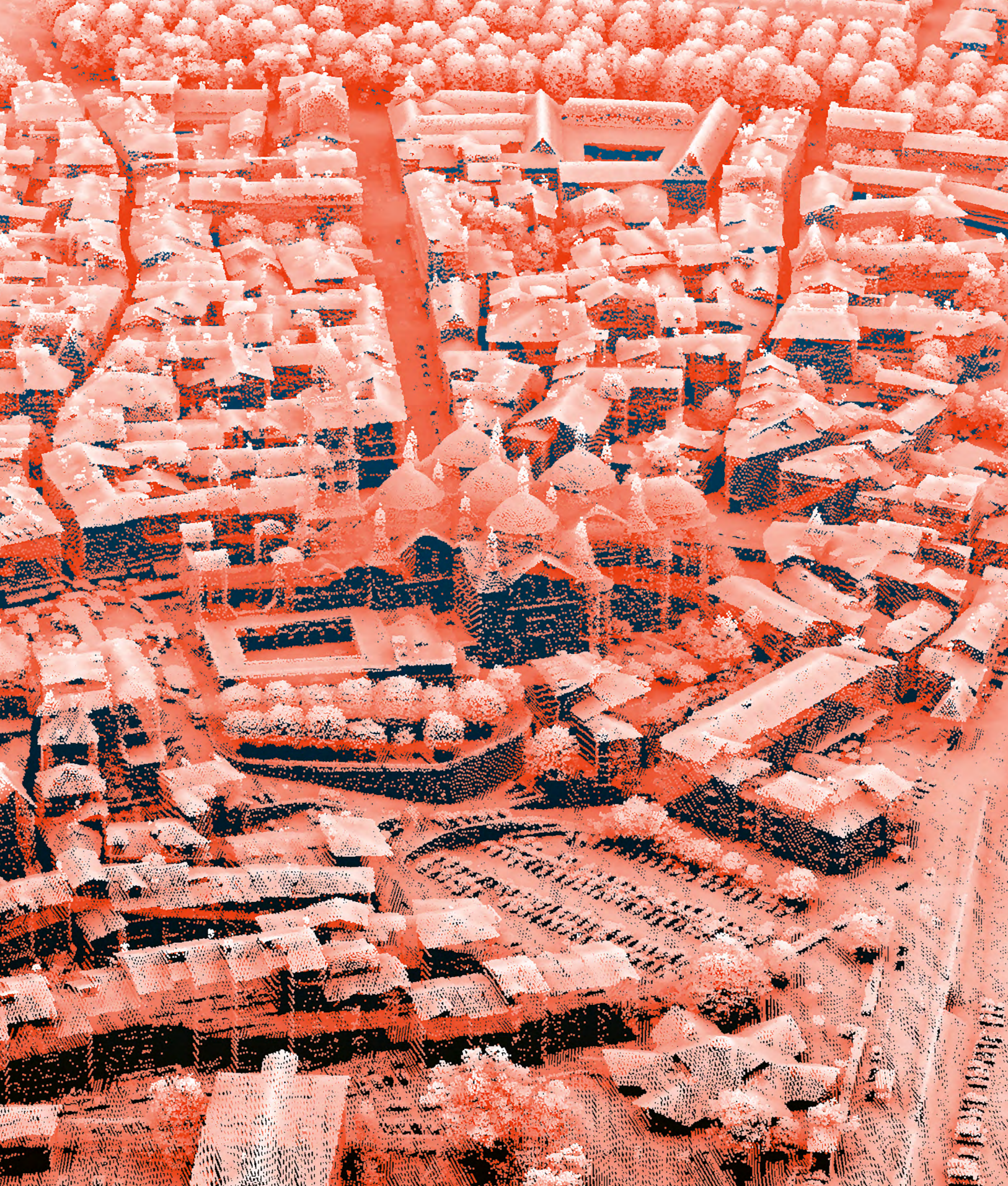
LIDAR HD POUR LA RÉALISATION DU FUTUR Jumeau NUMÉRIQUE LIEU : PÉRIGUEUX (DORDOGNE) Date : 2021
