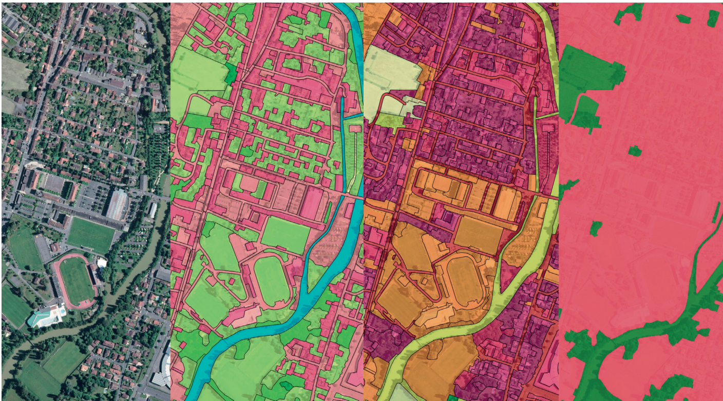
Mesure de l'artificialisation des sols — De gauche à droite : photo aérienne, couverture du sol par IA, usage du sol, zones artificialisées Lieu : Auch ; Date : 2019
